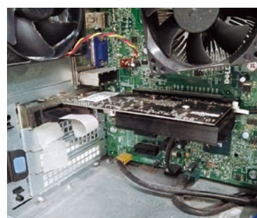
こちらがスロットにグラフィックボードを取り付けたものになります
