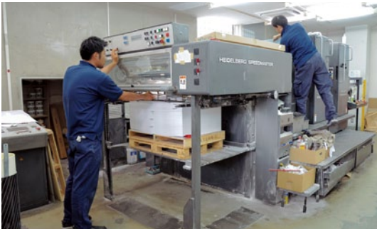
弊社メイン機種、スピードマスター102ZP。 頁物印刷にバリューを発揮する両面印刷機です。
